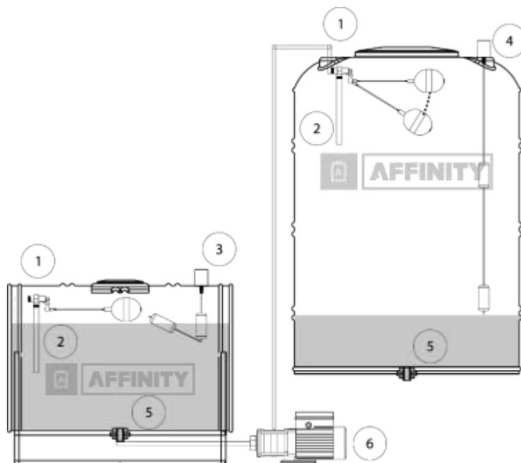
(Dibujo 1.3) Ejemplo de sistema de bombeo con tanque de reserva y cisterna.
